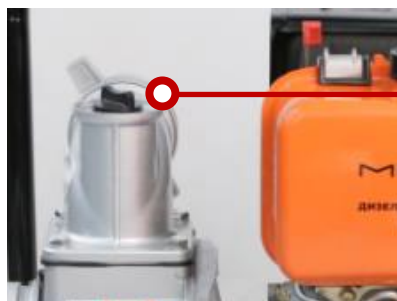
Заливная горловина. Перед первым пуском достаточно залить воду в корпус мотопомпы, воздух во всасывающем шланге она прокачает сама.
